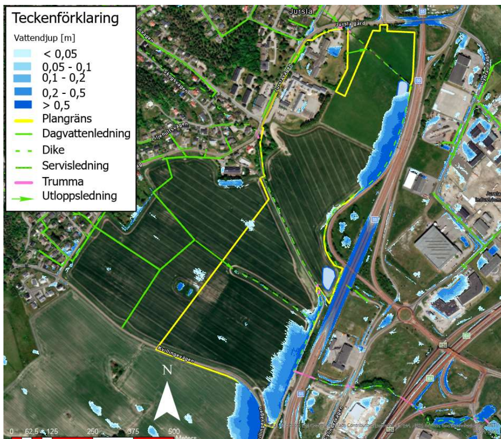
Figur 22. Ytor inom och nära planområdet som bedöms ha risk att översvämmas vid ett 100-årsregn på 50 millimeter.
