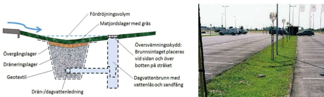
Figur 21. Till v: Princip över infiltrationsstråk. Till h: Infiltrationsstråk v i anslutning till parkering (Bildkälla: Stockholm vatten och avfall).
