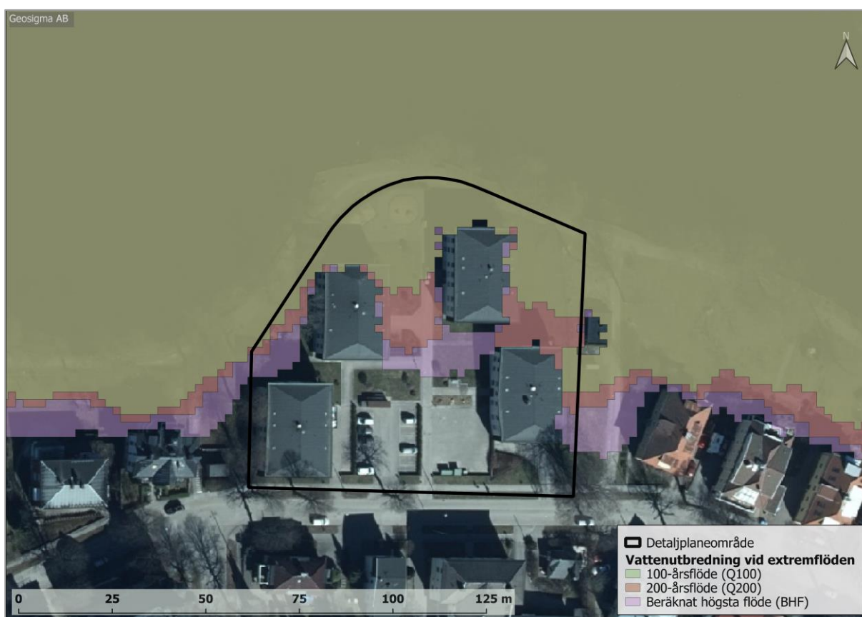
Figur 4-16. Kartan visar hur vattennivåer i Motala ström påverkar vattenutbredningen på land i samband med ett beräknat 100-årsflöde, 200-årsflöde samt beräknat högsta flöde. Planområdet har också markerats med en svart polygon. Aktuella byggnader inom Braxen är pålgrundlagda och markytan utgörs överst av gräsbevuxen mark.
