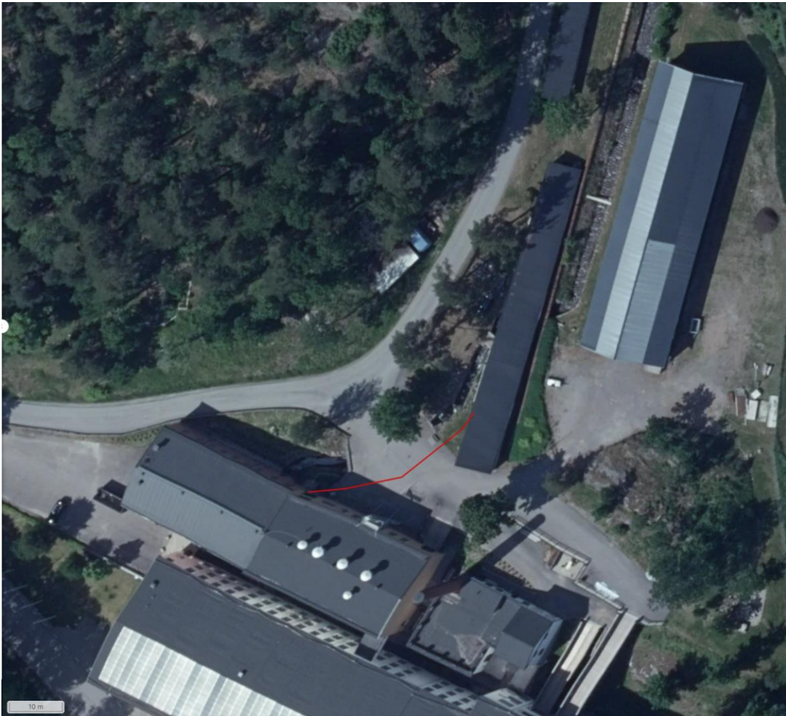
Figur 15. Den röda linjen visar var den tillfälliga vallen lades in i modellen för att undvika att vatten som strömmar över vägen när betongkulverten går full inte rinner vidare mot Vigognespinneriet.
