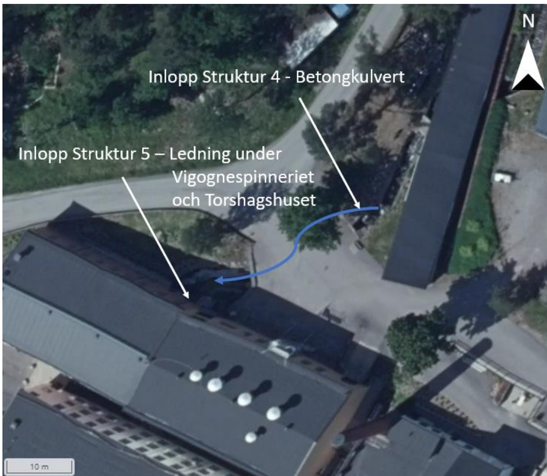
Figur 19. Betongkultverten uppströms Vigognespinneriet har inte tillräckligt med kapacitet vid flöden över 2,2 m 3 /s. Vattnet strömmar över vägen, vidare mot inloppet till kanalen under Vigognespinneriet och Torshagshuset.
