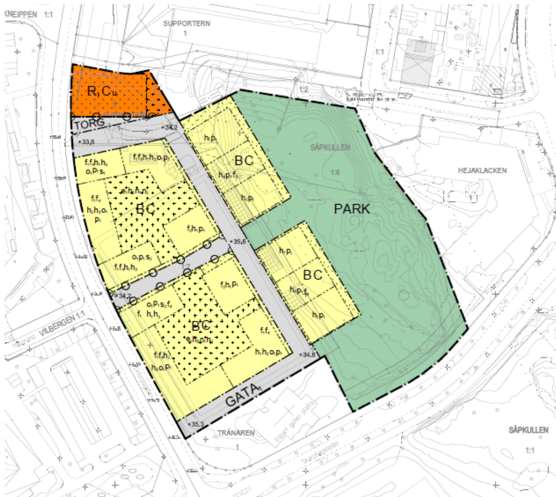
Figur 10. Plankarta Säkullen 1:2 (källa www.norrköping.se). Notera att planerad bebyggelse går in i slänt och att jord- och bergschakt kan förutsättas vid Helgeberget för att grundlägga husen, samt hur detaljplan i norr och nordöst avslutas mot fastighetsgräns.
