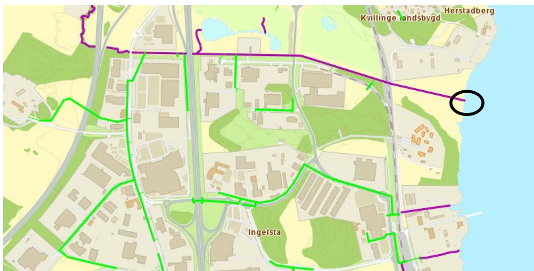
Figur 4 Karta över dagvattenledningar (gröna linjer) och diken (lila linjer) för berört område, DIKA.
