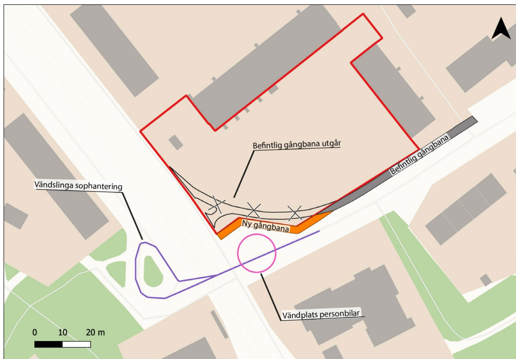
Figur 10. Planförslagets konsekvenser på gatenätet, inkluderat schematisk illustration av förslag på nya lösningar för trafiken. Karta: Norrköpings kommun.
