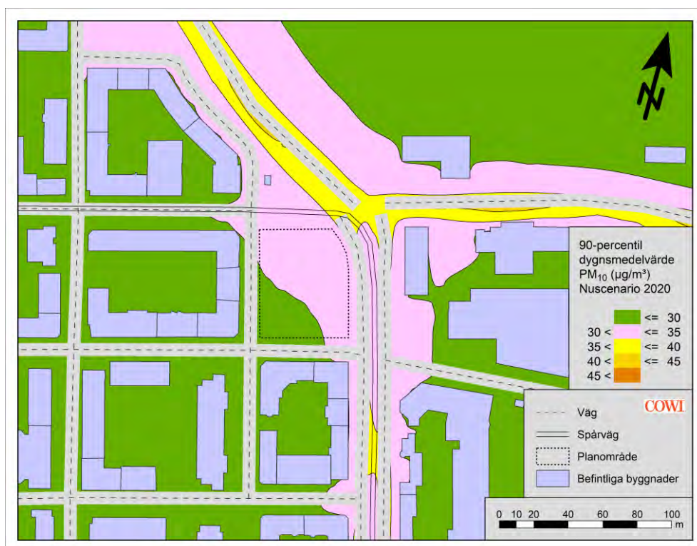
Figur 11. 90-percentilen av dygnsmedelvärdet av PM 10 (µg/m 3 ) för nuläget. Rosa haltnivå visar gränsen för miljö kvalitetsmålet.
