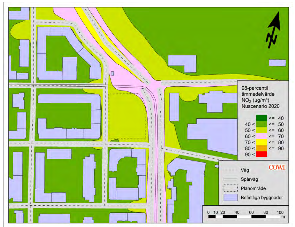
Figur 6. 98-percentilen av timmedelvärdet av NO 2 (µg/m 3 ) för nuläget. Röd halt-nivå visar gränsen för MKN och rosa gränsen för miljö kvalitetsmålet.
