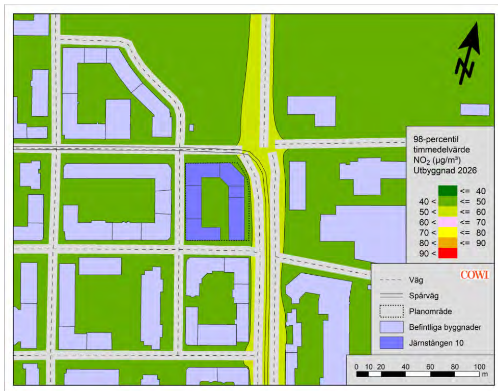
Figur 9. 98-percentilen av timmedelvärdet av NO 2 (µg/m 3 ) för framtidsscenarioet, år 2026. Röd halt nivå visar gränsen för MKN och rosa gränsen för miljö kvalitetsmålet.
