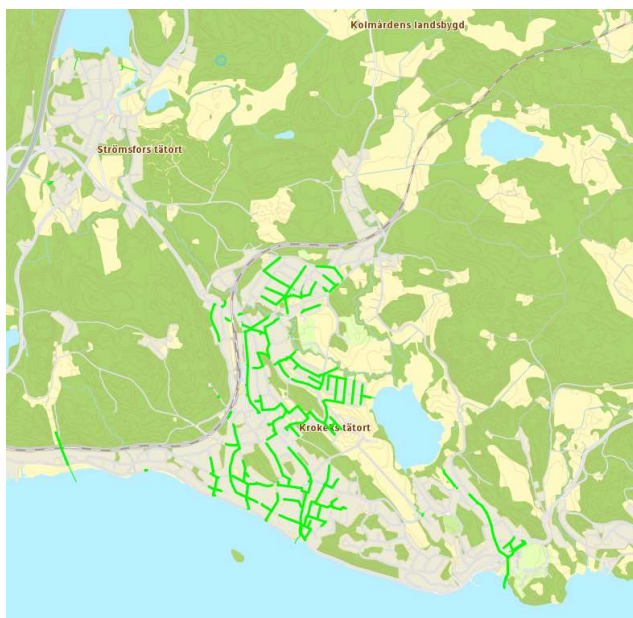
Figur 5. Dagvattensystem i området.
