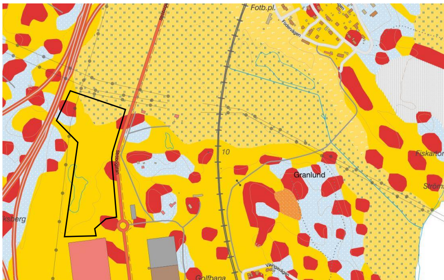
Figur 6. Utdrag från SGUs jordartskarta. Ungefärligt planområde markerat med svart linje. Gula områden är glacial lera. Ljusgula med blåa sträck är gyttjelera. Röda områden är berg i dagen och blåa områden utgörs av sandig morän (Nodra, 2022).
