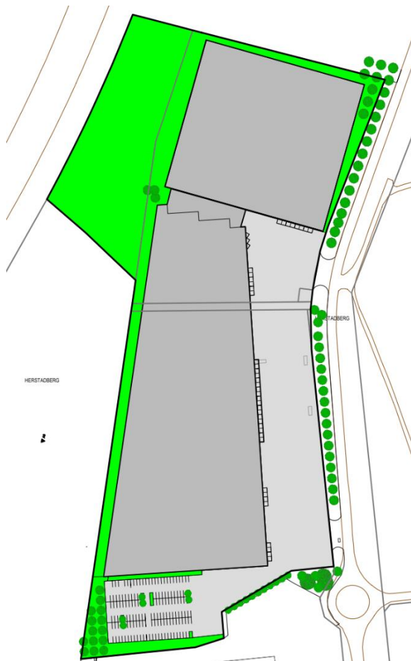
Figur 17. Ytkartering av framtida markanvändningen inom planområdet, där takytor är markerade i mörkgrått, asfalterade parkeringsytor i ljusgrått och grönytor i grönt.
