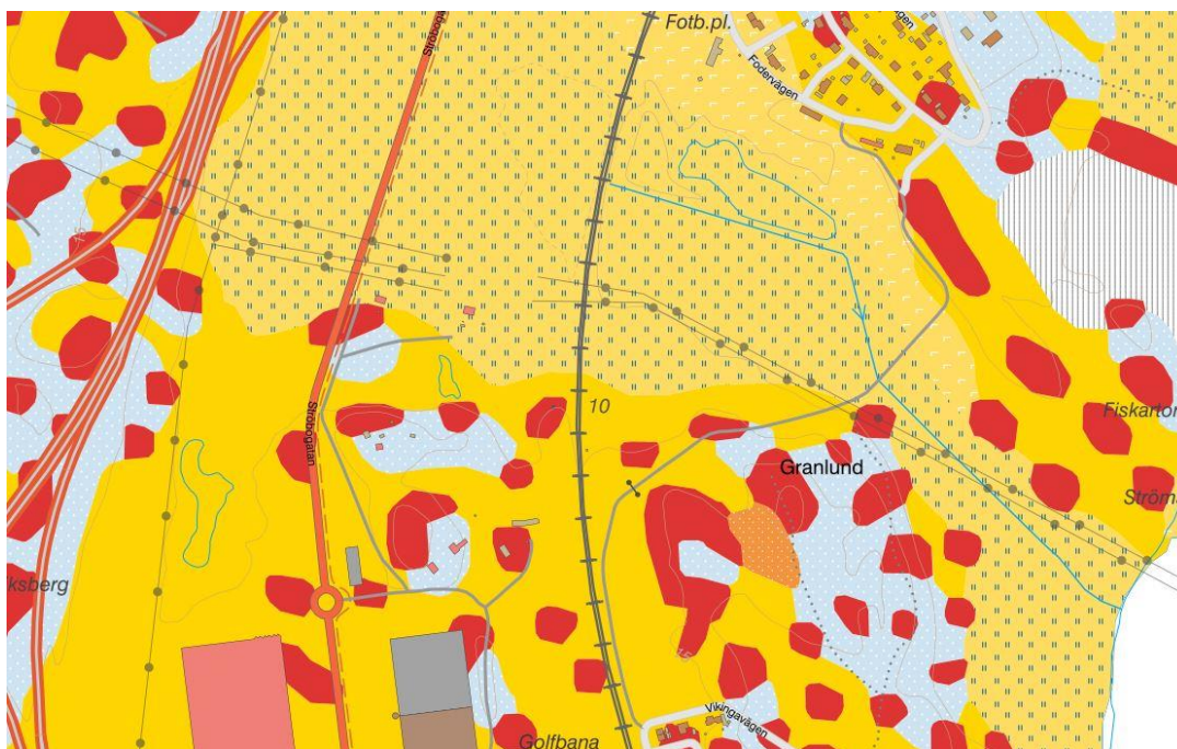
Figur 5 Utdrag från SGUs jordartskarta. Gula områden är glacial lera. Ljusgula med blåa sträck är gyttjelera. Röda områden är berg i dagen och blåa områden utgörs av sandig morän.
