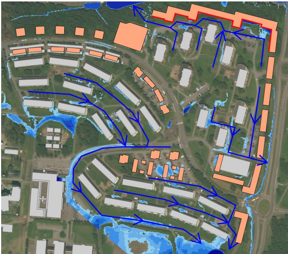
Figur 4 Förslag till lämplig placering av lågstråk för yttlig avledning av dagvatten.
