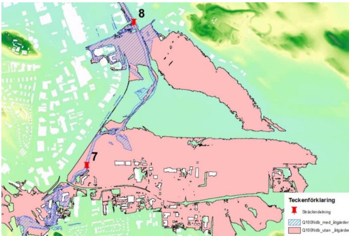
Figur 17. Vattenutbredning vid flöde från 100-års regn med åtgärdsförslag från modelleringssteg 1 och utan åtgärd. Källa: (WSP)
