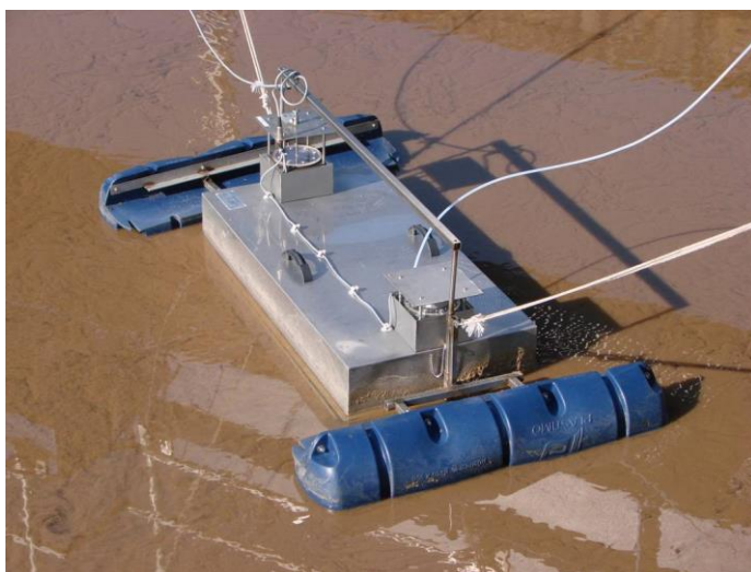
Figur 3-4 Luktprovtagning på en yta
