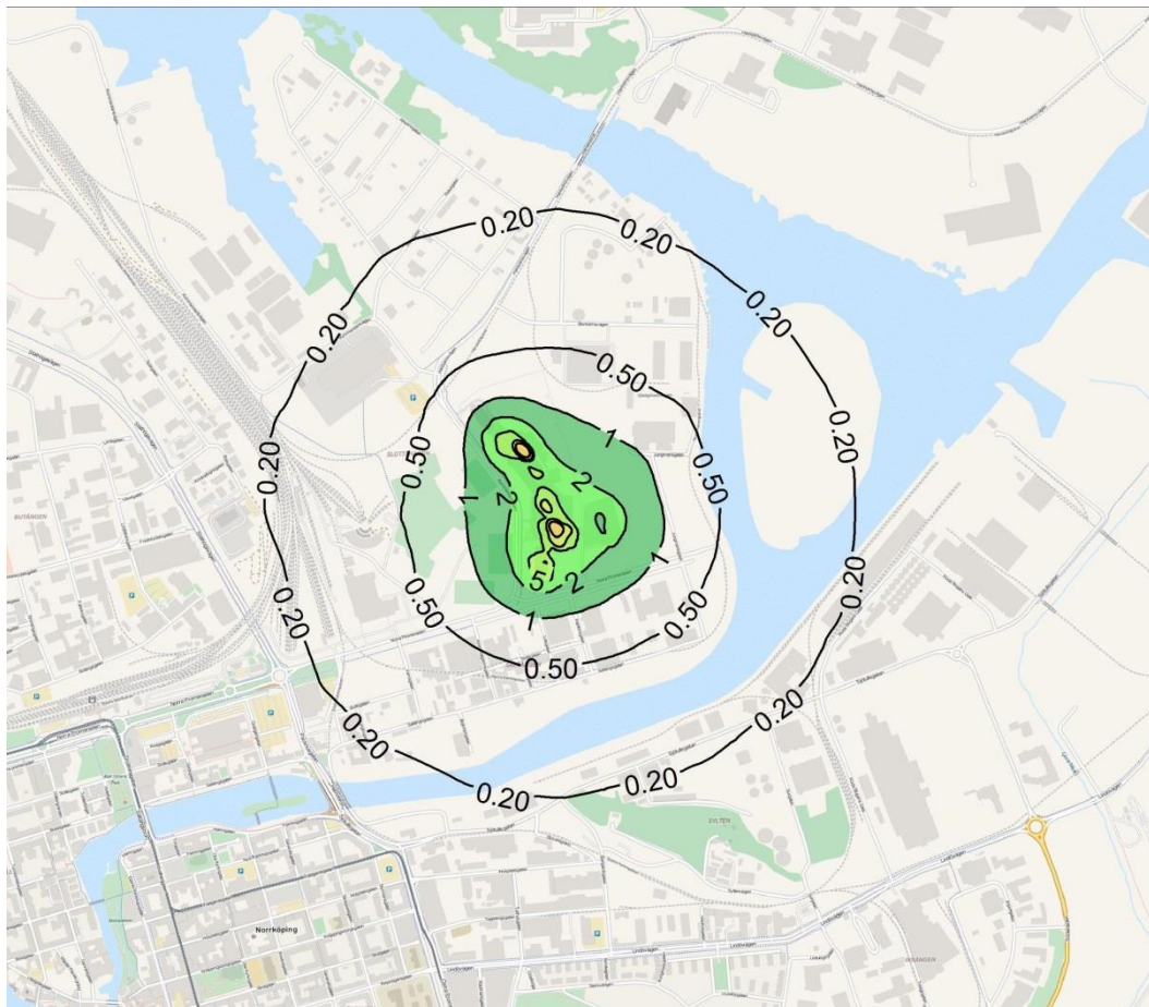
Figur 7-6 Scenario 5 Resultat spridningsberäkning – som Scenario 4 samt inbyggnad av slamutlastning som 99 %-il av högsta minutmedelvärden.
