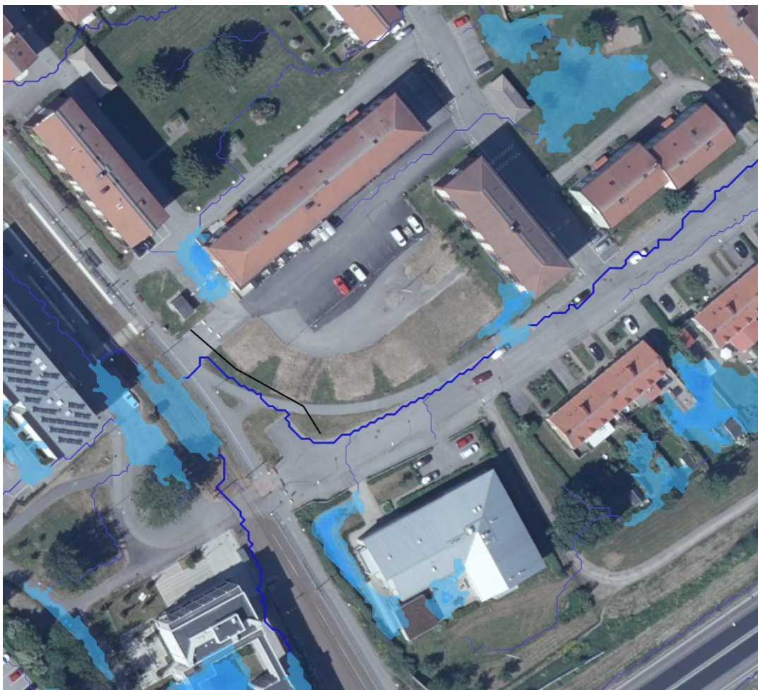
Figur 13 Möjlig placering av en vall som kan styra rinnvägen förbi planområdet.
