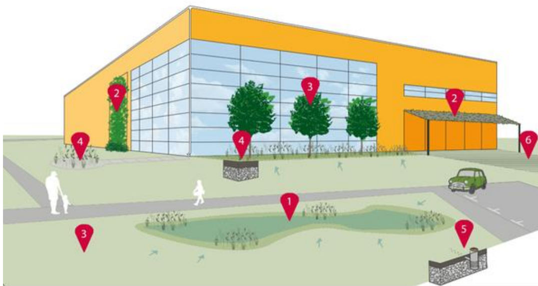
Figur 16. Exempel på olika åtgärder som kan vidtas för att hantera mindre regn inom fastigheten. För förklaring av siffror, se Tabell 8.
