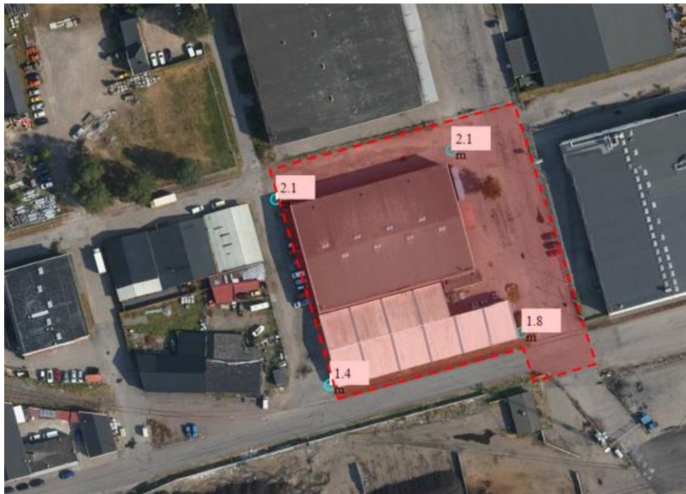
Figur 18. Kartbild som visar befintliga höjder i området och som ska vara utgångspunkt för den lastkompensation som behöver genomföras i området. Karta: Norrköpings kommun.
