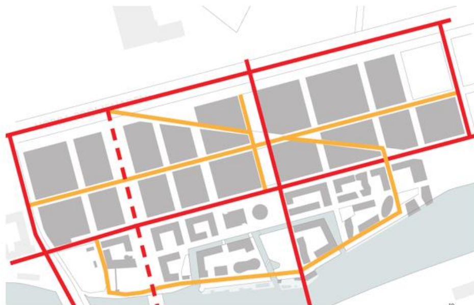
Figur 22. Trafiknät för cyklister inom inre hamnen. Heldragen rödlinje: huvudcykelnät, streckad röd linje: framtida huvudcykelnät, heldragen orange linje: lokalt cykelnät. Bild: Norrköpings kommun.
