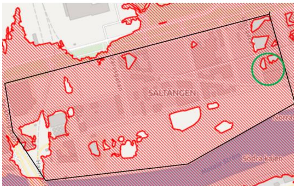
Figur 23. Beräknad havsnivåförhöjning för 100-års havsvattennivå (+2,38 meter) år 2100 som visas med röd skraffering. Området för Inre hamnen visas markerat med svart linje. Bilden visar Inre hamnen innan marknivåer höjts. Svanen 5 är markerat med en grön ring. Bild: Norrköpings kommun.
