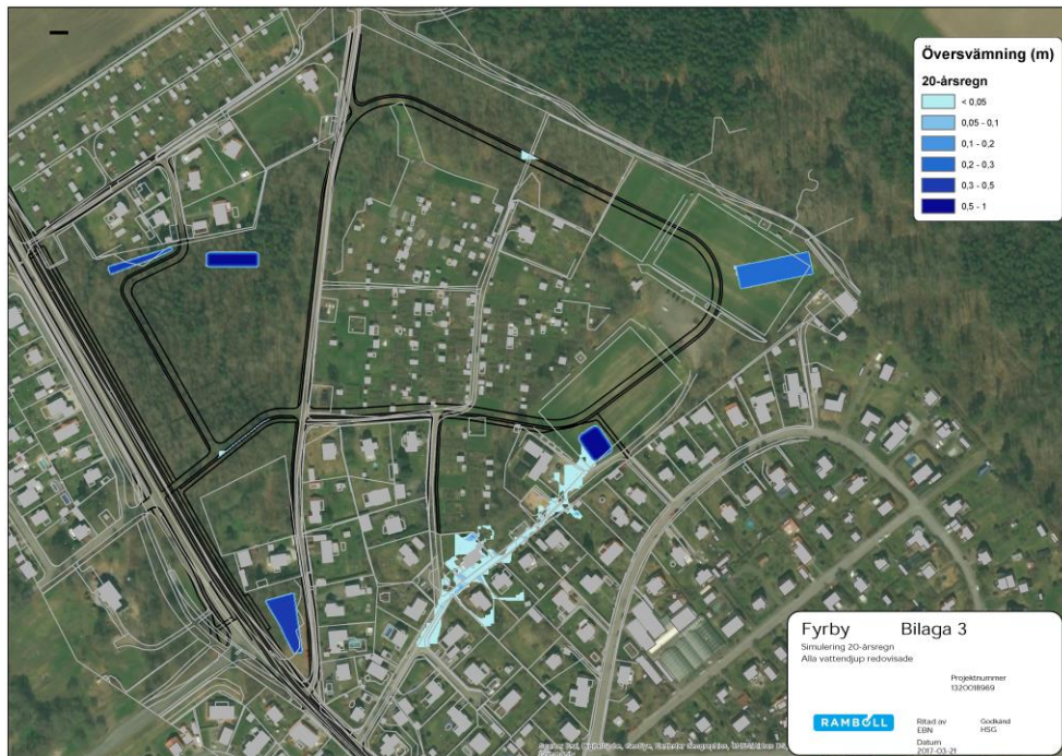
Figur 18. Översvämningssanalys vid 20-års regn. De mörkare områdena är där dagvattendammar och fördröjningsåtgärder har föreslagits i detaljplanen.
