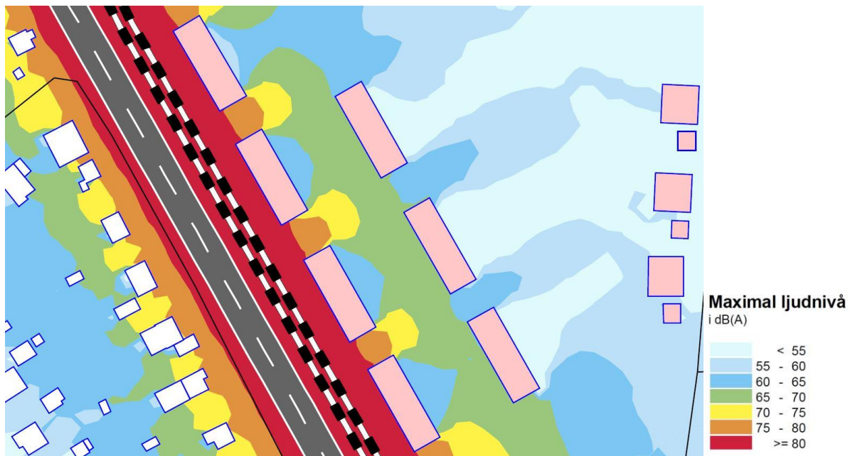
Figur 15. Karta bullerberäkning med ungefärligt läge för planerad bebyggelse, maximala nivåer, med planerad bebyggelse i beräkningarna. Tyréns 2016.
