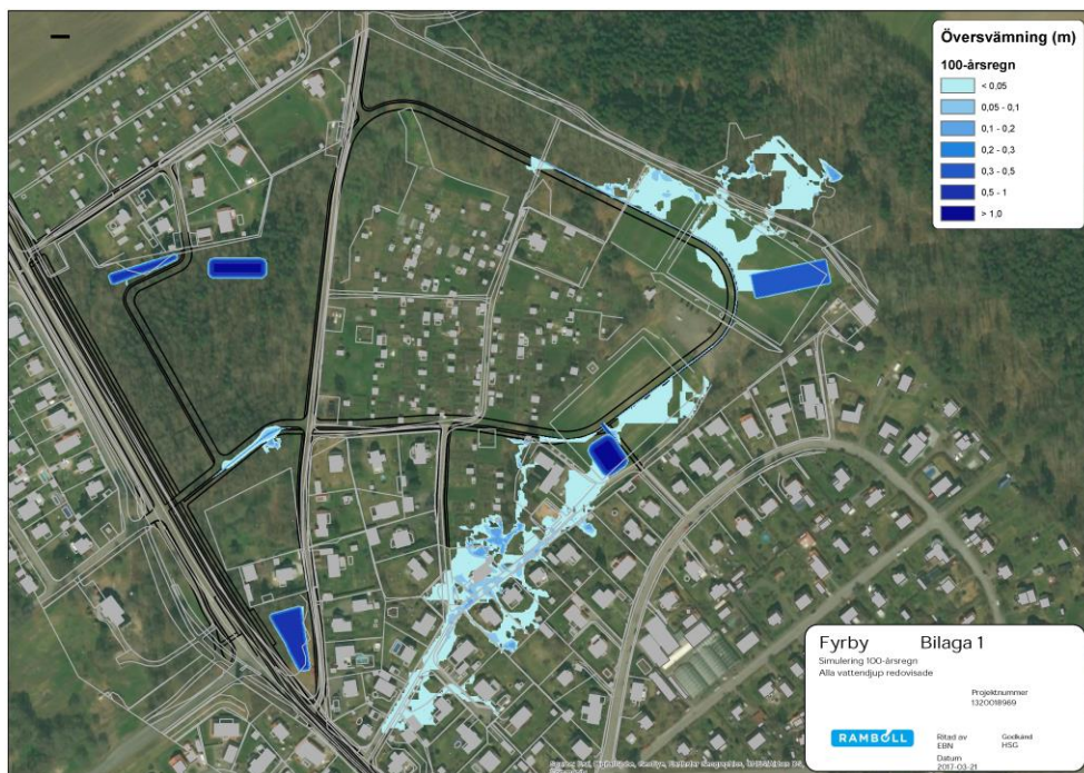
Figur 19. Översvämningssanalys vid 100-års regn. Här kan de befintliga byggnaderna i söder som löper risk för översvämning synas, inklusive de tomter i nordöst som löper risk om inte marknivån höjs i och med byggnation.
