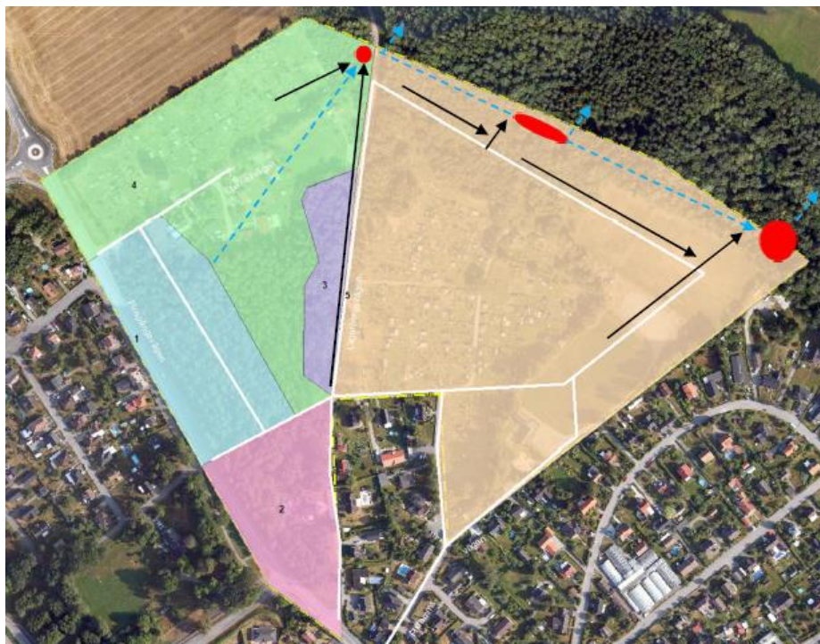
Figur 17. Indelning av utredningsområdet i delområden samt principer för möjlig dagvattenhantering. Streckade pilar motsvarar öppet dike och heldragna pilar motsvarar ledning, alternativt dike. Röda markeringar motsvarar möjliga lägen för fördröjning. Källa. Tyréns, Dagvattenutredning Fyrby, 2016-02-05 .
