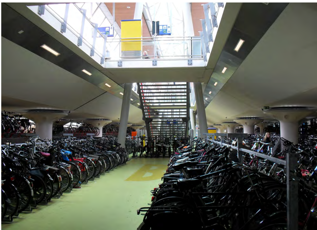
Bilden visar hur väderskyddad cykelparkering kan ordnas på ett resecentrum. Cykeln körs in och parkeras i markplanet, därefter tar man trappan för att komma upp till järnvägsplattformarna. Exempel från Houten, Holland Foto: Martin Berlin.
