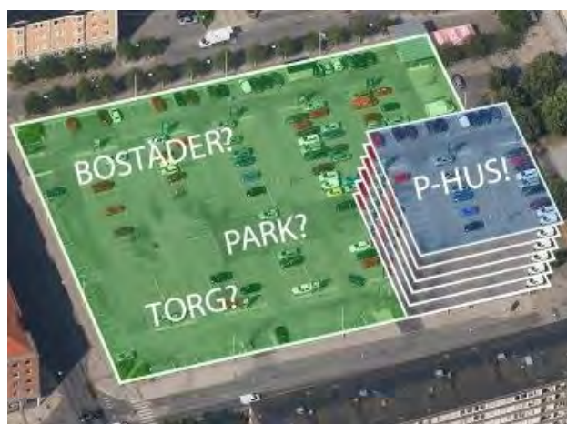
Bilden visar hur p-anläggning i 6 plan möjliggör att 5/6 av ytan kan användas till annat. Illustration: Linda Gärlin
