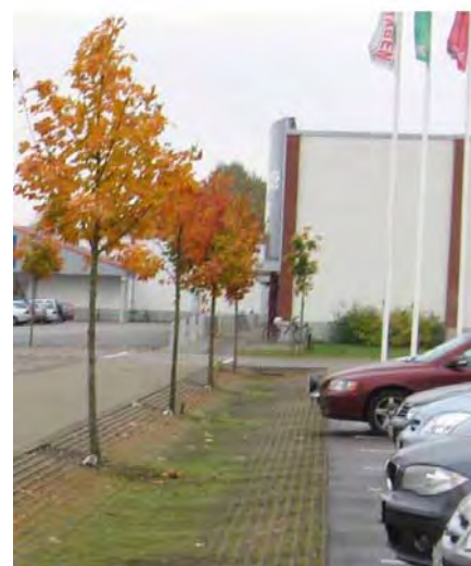
Exempel på parkeringsplatser med armerat gräs samt avdelning av parkeringsytor med vegetation och trädplanteringar för dagvattenhantering.
