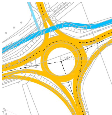
Figur 7 - Skiss över den utformning av Lindörondellen som ligger till grund för trafikanalys
