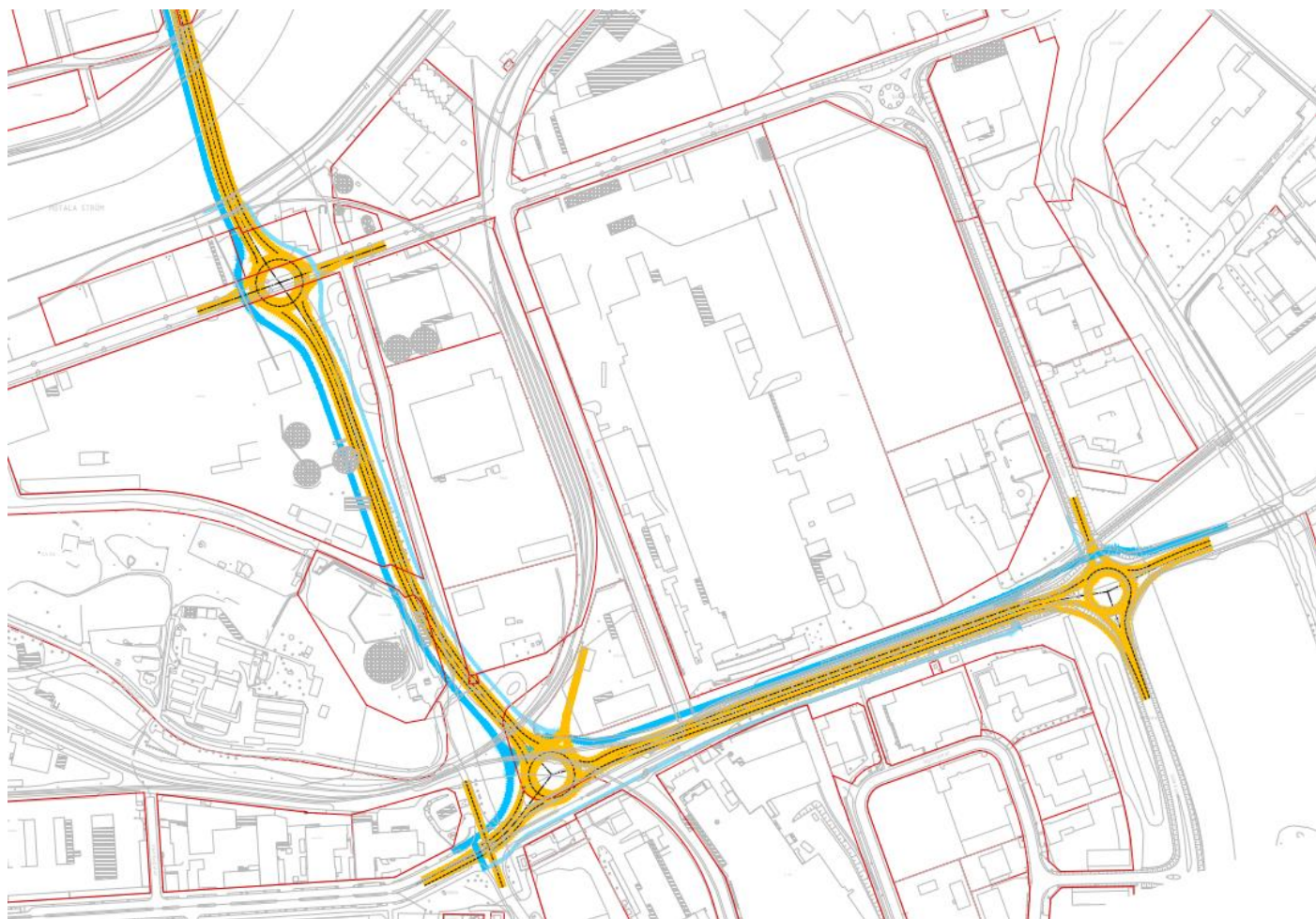
Figur 5 – Utformning med fyrvägskorsning på Lindövågen samt med extra anslutning till Rödastugans gata.
