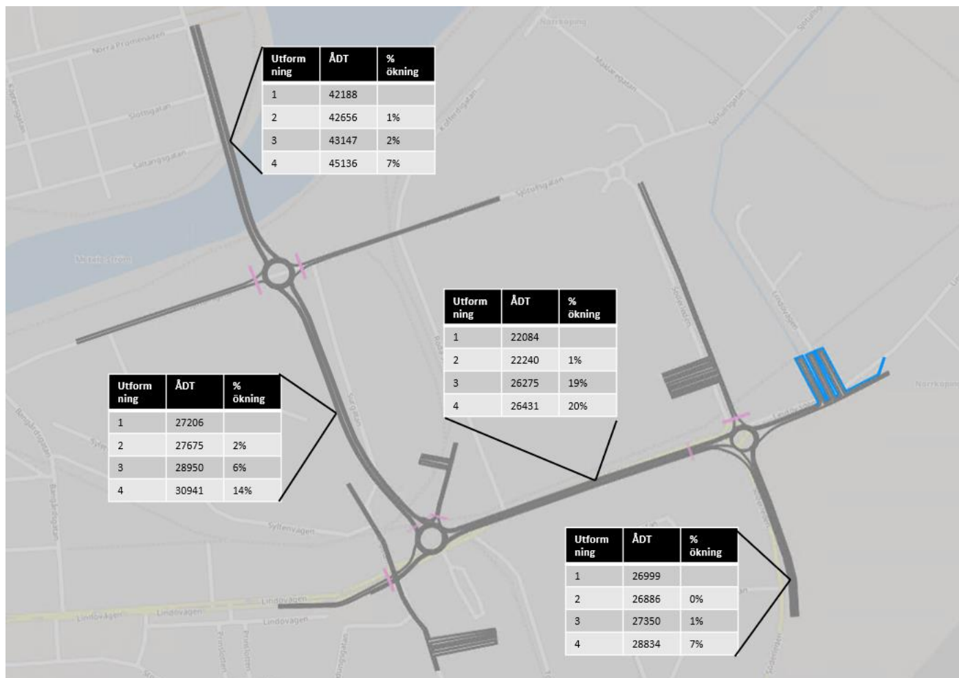
Figur 59 - Extra flödeskarta som redovisar förändringen i trafik beroende på utformning längs Lindökorridoren. Utformning 4 och utformning 5 har samma trafikflöde.
