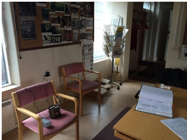
Figur 6. Bild över placeringen av luftpump för inomhusluftmätning och radonlogger i mätpunkt Byggnad 5.
