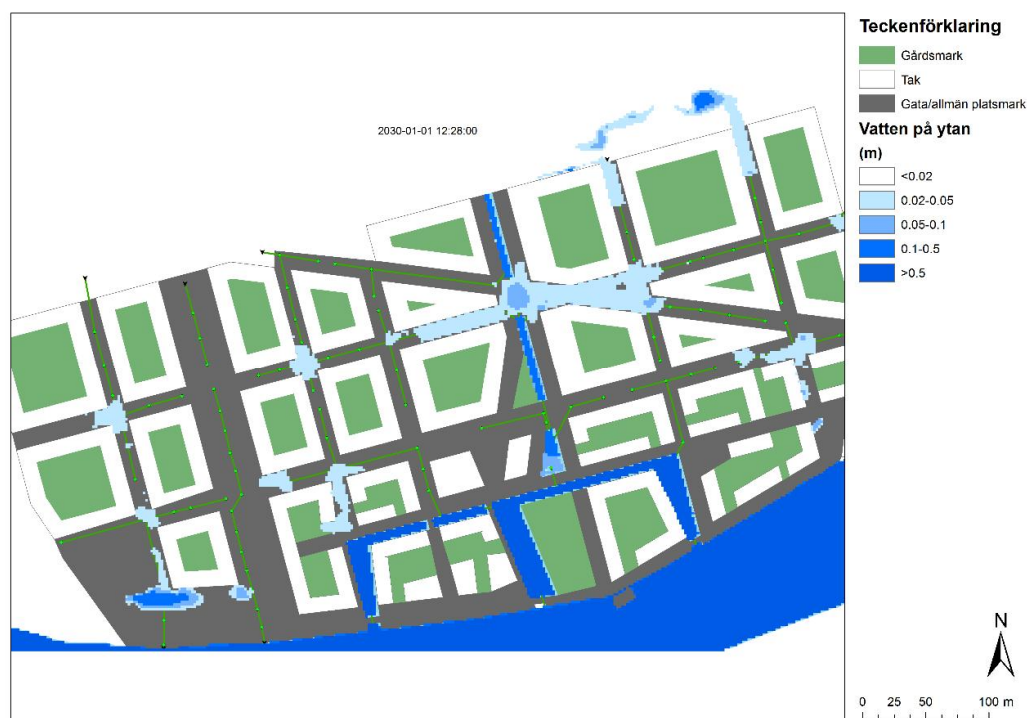
Figur 42. Översvämningar vid regn med 30-års återkomsttid med öppet dagvattensystem. Viss avledning sker på gatan (upp till 5 cm).
