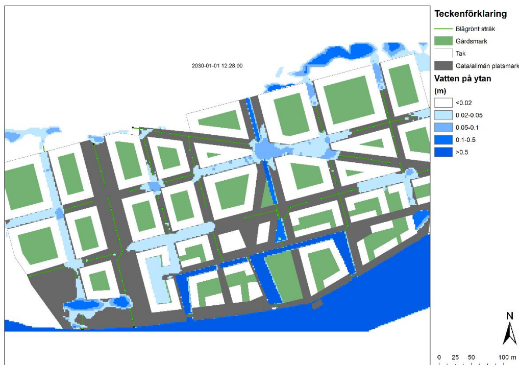
Figur 43. Översvämningar vid regn med 100-års återkomsttid med öppet dagvattensystem. Viss avledning sker på gatan (upp till 10 cm). Översvämningssyta i nedre vänstra hörnet och inom gårdsmark nedan till vänster beror på att använd höjdmödel här inte justerats tillräckligt för att skapa avrinning till Motala ström respektive djup kanal.
