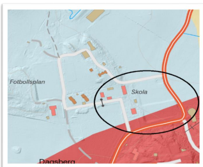
FIGUR 4. JORDARTSKARTA FRÅN SGU:S KARTGENERATOR. BLÅTT OMRÅDE ÄR MORÄNFÖREKOMST OCH RÖTT OMRÅDE ÄR BERGFÖREKOMST.
