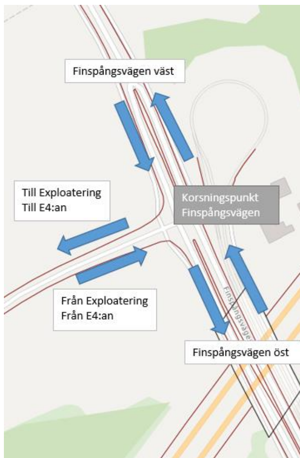
Figur 5 - Flödesriktningar för väjningsreglerad korsning
