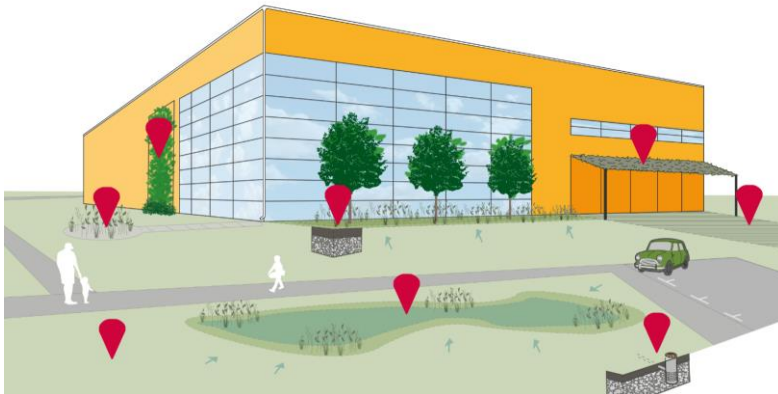
Figur 24. Förslag på hantering av de mindre regnen på kvartersmark. Illustration: Norrköpings kommun.
