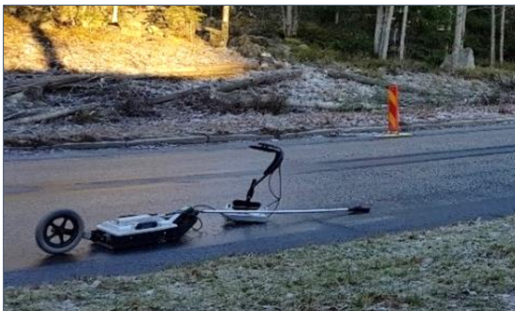
Figur 8. Markradarutrustning, Malå GX samt 450 mHz HDR antenn och terränganpassat mätjulk.
