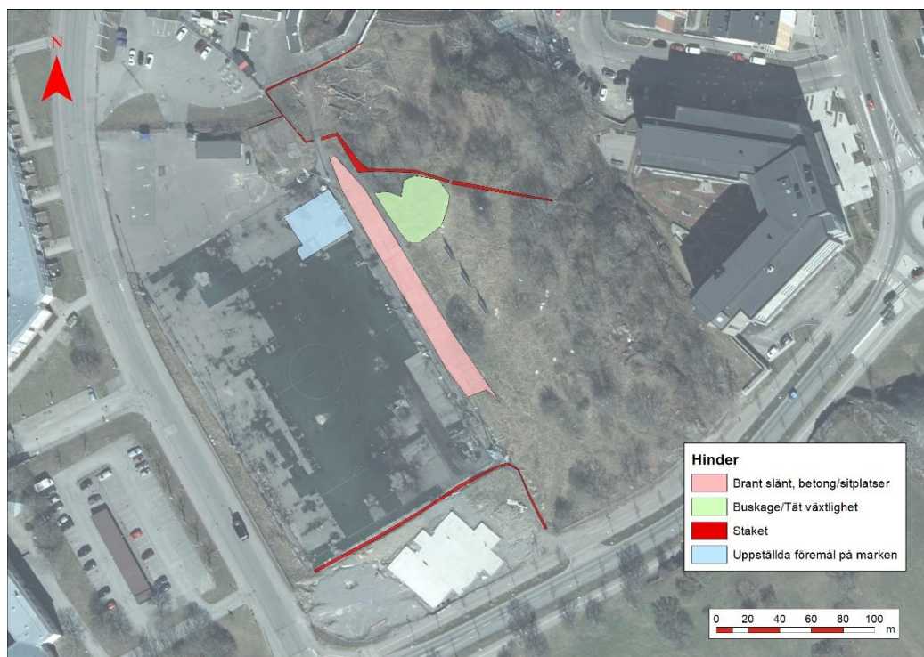
Figur 11. Bild på inmätta ytor som representerar övriga hinder på marken och övriga områden som omöjliggör utförande av radarmätningar.
