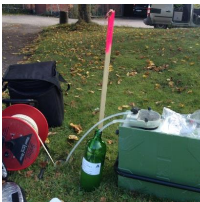
Figur 5. Provtagning av grundvatten med peristaltisk pump.
