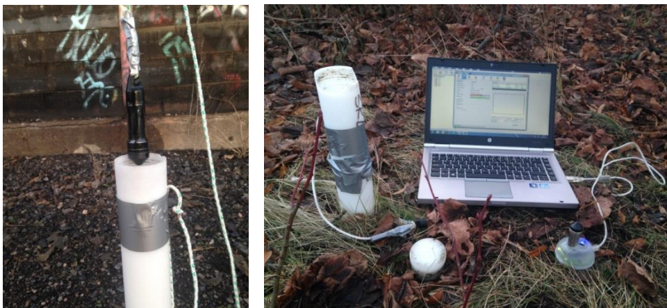
Figur 6. Upptagning och avläsning av divers och barometer.
