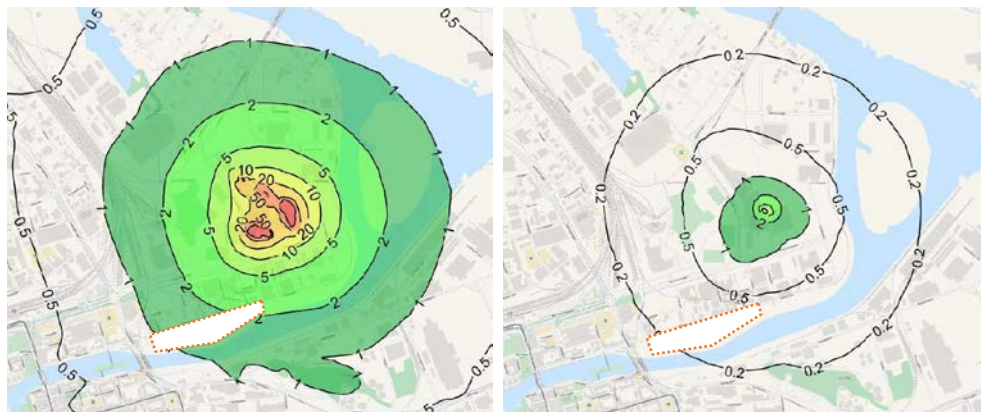
Bild som visar det område där lukt kan uppkomma med normal belastning vid reningsverket som skulle kunna föranleda störning för boende. Planområdet markerat. ÅF Industry AB.
