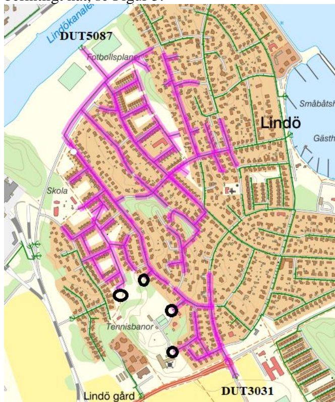
Figur 5 Befintligt dagvattennät med möjliga anslutningspunkter för planområdet.
